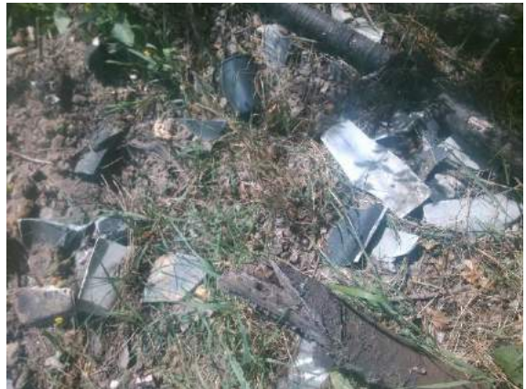
Foto 4: Asbestverdachte materialen ter plaatse van boring 11/gat 11.
