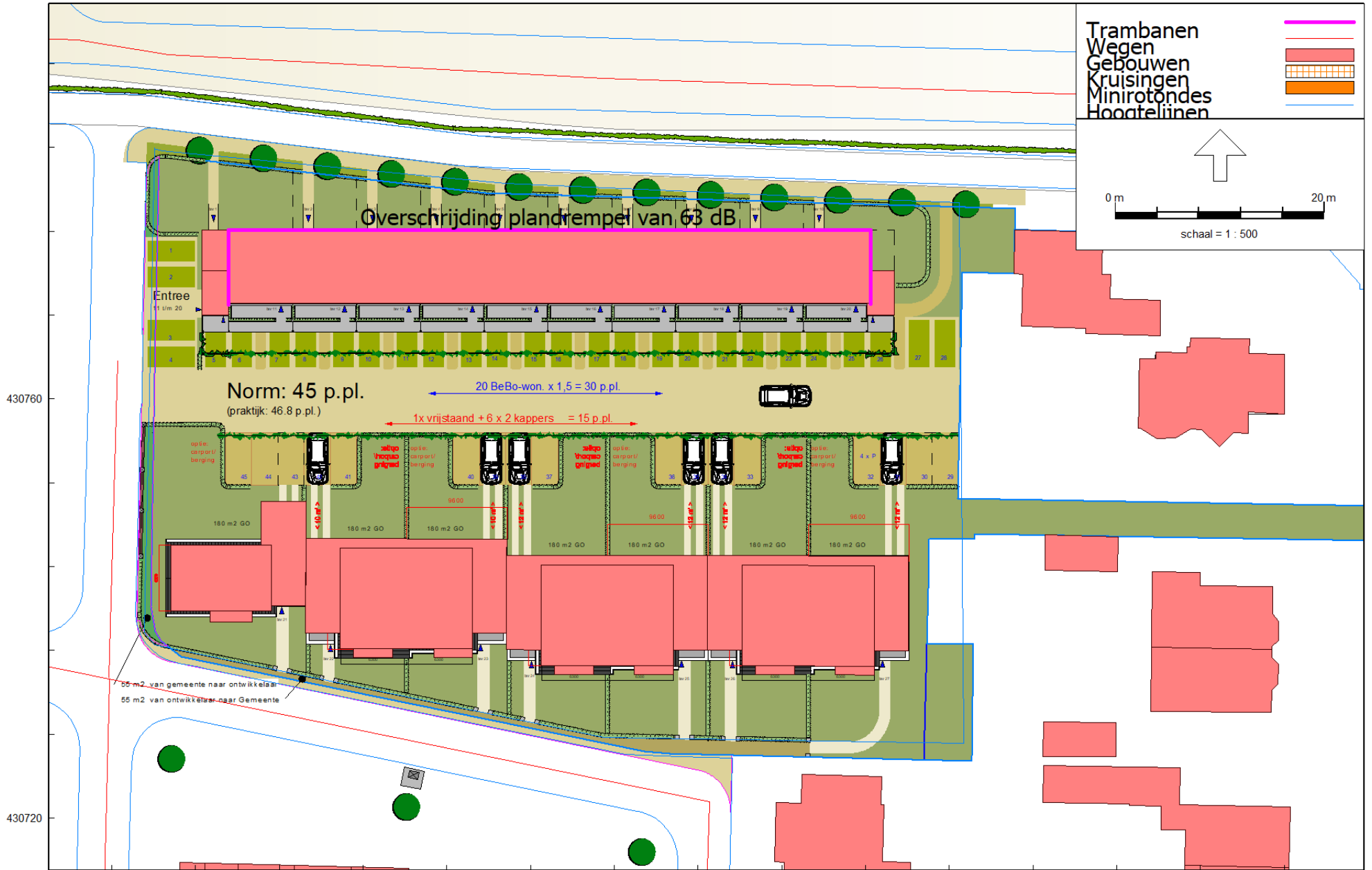
Wegverkeerslawaai - RMG-2012, wegverkeer, [Ruimtelijke onderbouwing Hof van Barendrecht; oktober 2022 - Afbeelding dove gevels en gevels met overschrijding plandrempel], Geomilieu V2021.1 Licentiehouders: KuiperCompagnons
