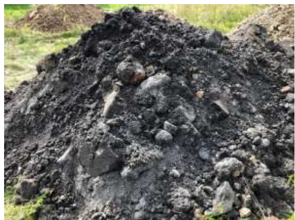
Foto 6: overzicht ontgraven stortmateriaal
